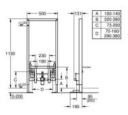
Pour mur porteur ou non-porteur. Châssis en acier finition époxy. Complètement préassemblé. Raccords réglables en hauteur. Verrouillage de la hauteur. Livré avec matériel de fixation. Fixation pour bidet. Coude d'évacuationDN 50. Joint 32 mm. 2 raccords de robinetterie DN 15. Matériel de fixation pour bidet. Pour une installation murale, munissez-vous des supports muraux 3855800M (Réf QA: 300285).
