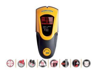
Il localise de façon aisée et rapide le centre et les bords de montants en bois ou solives en métal derrière les murs, plafonds et planchers jusqu'à une profondeur de 76 mm. Un inverseur à 3 positions permet un changement de mode aisé, tandis que l'afficheur rétroéclairé. ultra-brillant, le pointeur SpotLite® et un signal sonore indiquent tous la position de la cible. L'indicateur de puissance du signal permet de distinguer entre des cibles profondes ou non.
