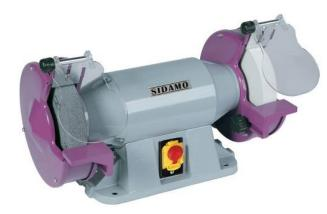
Corps en fonte d'acier. Montage sur roulements à billes étanche auto-lubrifiés. Interrupteur à bobine à manque de tension. Arrêt coup de poing à accrochage. Ecrans de protection en polycarbonate. Protection thermique automatique interne au moteur. Carters en acier embouti équipés d'une buse de captage des poussières. Pare-étincelles et porte-outils réglables à 2 mm de la meule.
