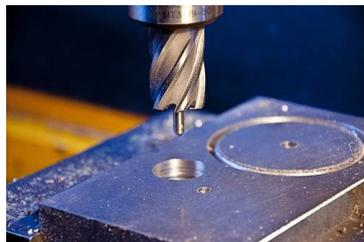
Pour usage des fraises à carotter Weldon sur machine Fein. Queue Weldon : queue cylindrique à méplats de 3/4 de pouce. Particulièrement adaptée pour l'attachement des outils sur perceuses à embase magnétique.
