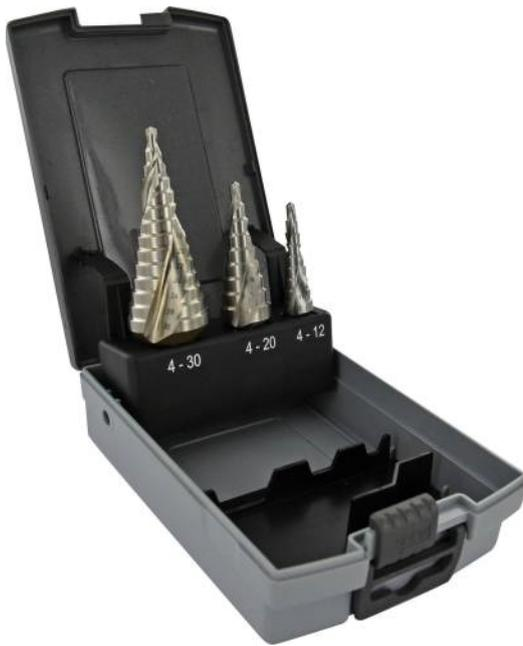
Foret performant pour le perçage rapide et intensif des aciers résistants grâce à sa goujure hélicoïdale et son affûtage auto-centrant. Auto-centrage de la pointe. Queue à 3 méplats. Acier rapide. Pour les usages généraux dans l'acier jusqu'à 950 N/mm<sup>2</sup>, les fontes et les aluminiums.
