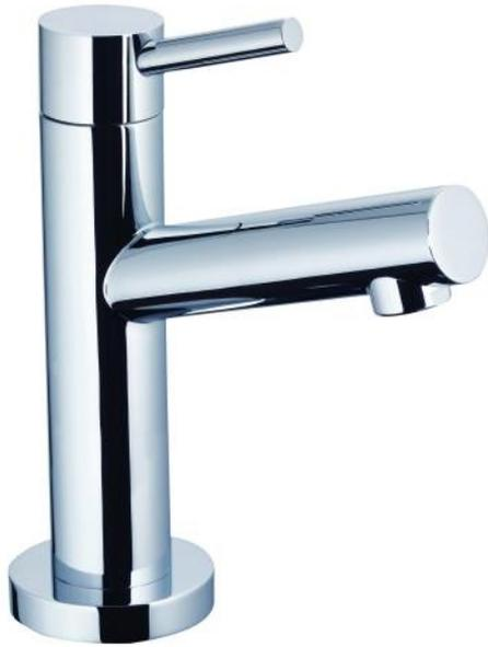
Corps laiton, poignée métallique. Bec fixe. Tête à disque céramique 1/4 tour. Aérateur M18x100. 1 écrou de fût 1/2". Pour eau froide uniquement. Garantie 5 ans.
