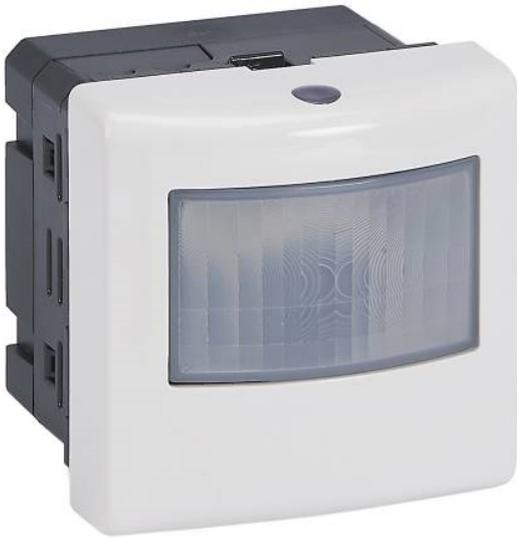
Mosaïc, un détecteur répondant aux tendances actuelles des bâtiments à compléter d'une plaque de finition et à poser sur tous types de supports. Permet la commande de lampes LEDs et fluocompacts : 100W, LEDs, CFLs, halogènes, tubes fluo avec ballast ferromagnétique ou électronique : 150VA et halogènes : 150W. Câblage 2 fils avec neutre. À équiper d'un support et d'une plaque Mosaïc. Compatible avec boîte profondeur 40mm.
