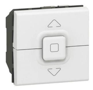
Mosaïc, une commande de volets roulants répondant aux tendances actuelles des bâtiments à compléter d'une plaque de finition et à poser sur tous types de supports. Pour commande directe montée, descente et arrêt de moteur de volet, store ou bannes jusqu'à 500W maximum. Repéragedes bornes facilitant le câblage. Connexion par bornes automatiques à levier permettant la connexion rapide sans outil.
