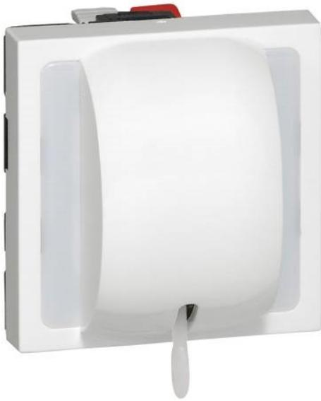
Mosaïc, une commande d'éclairage répondant aux tendances actuelles des bâtiments à compléter d'une plaque de finition et à poser sur tous types de supports. Va-et-vient à tirage Mosaïc 10AX - 250V. À équiper d'un support et d'une plaque Mosaïc. Repérage des bornes facilitant le câblage. Connexion par bornes automatiques à levier permettant la connexion rapide sans outil. Livré avec cordon longueur 1,5m.
