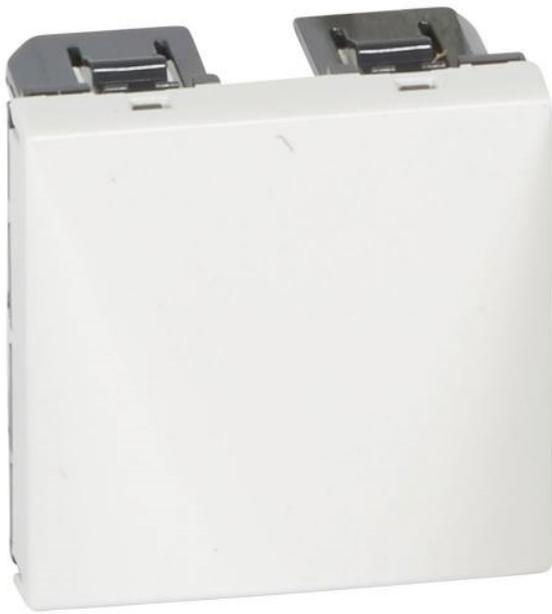
Mosaïc, sortie de câbles répondant aux tendances actuelles des bâtiments à compléter d'une plaque de finition et à poser sur tous types de supports. Avec serre-câbles. Pour câble de Ø4 à 12mm. Montage en monoposte ou en multiposte avec les autres appareillages Mosaïc.
