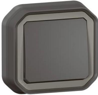
Plexo complet encastré, une commande d'éclairage étanche idéale pour les lieux humides. Interrupteur ou va-et-vient 10AX. Connexion rapide sans outil avec repérage couleur. Produit complet, prêt à être installé sur une boîte d'encastrement à vis. IP55 : protégé contre les poussières et les projections d'eau à la lance de toutes directions. IK08 : résistance à un choc de 5 joules.
