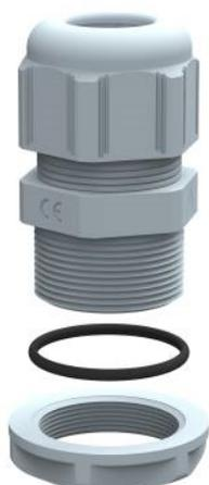
Serrage mécanique anti-vibration avec bague d'étanchéité néoprène pour IP 68. Gris RAL7001. Partie bloquante constituée de lamelles flexibles exerçant une forte pression sur le câble et conférant au produit une tenue optimale à la traction. Filetage PG. Conformes aux recommandations des guides UTE C 68-300 et 68-311.
