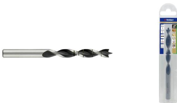
Foret performant et précis dans tous les types de bois grâce à son affûtage 3 pointes et ses goujures grand dégagement. Maîtrise de la profondeur de perçage grâce à la graduation laser SLR. Acier carbone. Grand dégagement copeaux. Pointe de centrage. Attachement cylindrique.
