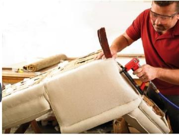
Idéal tapisserie, décoration, ameublement et cadre photo. Compacte et durable, l'agrafeuse Senco SFW09 pour agrafes fines permet de réaliser tous les travaux de rembourrage avec simplicité et facilité. Sa conception en métal et son profil épuré lui permet de fonctionner sans arrêt et sans accrocher ou griffer le tissu. Magasin à chargement par le bas. Poignée confortable. Echappement arrière. Bord long de 25mm.
