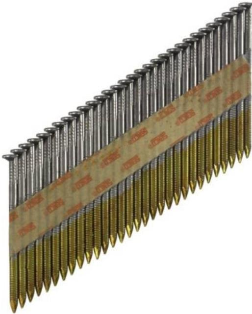
Clous en bande CH, tête D, tige annelé, pointe diamant avec un angle de liaison à 34° et un fil en carbone. Applications bois sur bois, construction en bois, charpente...
