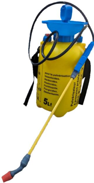
Pulvérisateur à pression préalable. Cuve en polypropylène graduée. Lance en fibre de verre avec buses à jets réglables. Pression 2 à 3 bars. Idéal pour pulvériser les herbicides, pesticides et fertilisants. Tuyau flexible : 1,20m haute résistance.
