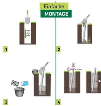
Fourreau à enterrer permettant de fixer un mât pour voile d'ombrage Premium. Fabriquée en aluminium. Trous compris pour le raccord au mât.
