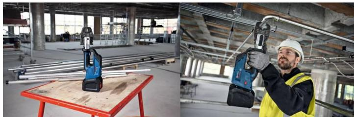
Sertisseuse 18V compacte et rapide avec pression de sertissage de 19 kN. Utilisation facile dans les espaces exigus grâce au design compact et à la tête orientable sur 360°. Sertisseuse pratique et rapide : réalise des sertissages en moins de 3 secondes. Un indicateur d'état à LED confirme qu'un cycle de sertissage a été concluant et avertit de problèmes éventuels. Grande robustesse et grand confort d'utilisation grâce au couvre-batterie.
