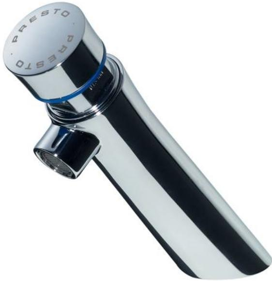
Robinet simple temporisé sur plage (eau froide) avec mécanisme à rubis auto nettoyé par fil frein et débit pré-réglé à 3L/mn. Réglage de débit interne. Temporisation de 15 secondes. Bouton poussoir anti-rotation avec marquage laser.
