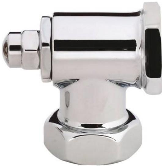
Ce robinet d'arrêt équerre départ écrou G1"1/4 prisonnier et joint, arrivée femelle G1" (pour tube diamètre 32mm) permet d'isoler l'alimentation de tout ou d'une partie d'une installation pour les robinets de chasse PRESTO Eyrem/ Eclair.
