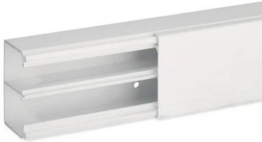
Système de goulottes de distribution double compartiments à cloison fixe pour la distribution et la séparation des courants forts et courants faibles. Idéal pour le cheminement de câbles et de fluides de même nature. Résistance mécanique 2,5 x plus élevée que celle exigée par les normes. Satisfait à l'essai au fil incandescent 960° (NF EN 60695-2-11). Clipsage aisé du couvercle et des composants. Socle symétrique et percé pour une fixation facile. Angles variables de 70° à 120°.
