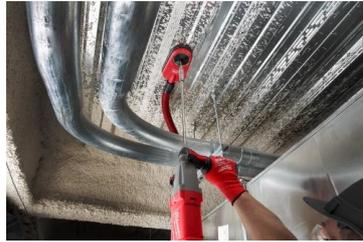
Extension universelle SDS-Plus pour étendre la portée des forets SDS-Plus. Système sans outils click & connect. Compatible avec tous les perforateurs et forets SDS-Plus. Optimal pour percer en zones confinées et pour percer au plafond. Permet le forage de trous profonds. Par exemple perçage dans béton armé sans avoir à acheter un foret long et coûteux.
