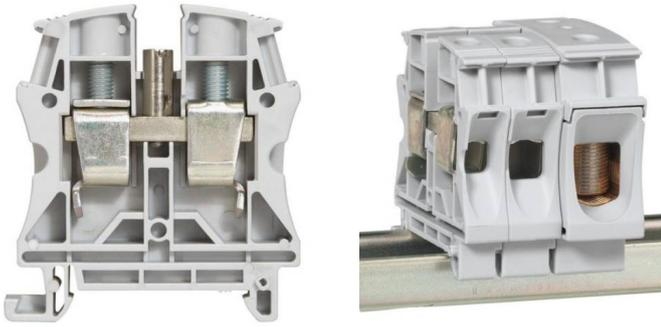
Bloc de jonction Viking 3 pour les circuits standards à connexion à vis permettant d'assurer la liaison électrique entre 2 conducteurs cuivre souples ou rigides. Un pion de solidarisation sur le corps isolant maintient les blocs Viking 3 entre eux ce qui facilite leur manipulation et contribue au parfait alignement sur le rail. Le montage et démontage d'un bloc reste néanmoins possible sans enlever les blocs adjacents. La forme ergonomique de l'entrée des conducteurs facilite leur insertion.
