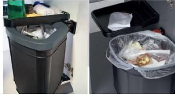
A fixer à l'intérieur du meuble (livré avec système de fixation). Pour meuble de 400 mm minimum. Les charnières de la porte doivent pouvoir s'ouvrir à 115° minimum (pour éviter tout problème d'extraction de poubelle). Ouverture automatique avec l'ouverture de la porte (triangle entraînant la poubelle). Fixation de la tablette sur un seul montant du meuble. Dimensions : 358x341x419mm
