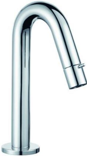
Robinet simple DN 15 commande sur la tête. Montage monotrou. Commande sur la tête actionnement par ergot. Partie supérieure spéciale avec passage pour axe régulateur de jet M 21,5 x 1. Débit 4,3L/ min à 3,0 bar. Fixation au socle G 1/2".
