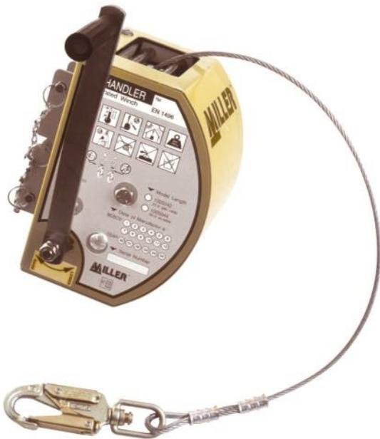
Compact et solide, le Manhandler est à la fois un treuil de sauvetage et de travail. Facile d'utilisation, son rapport de transmission (braquet) est de 5/1 avec un système de blocage en cas de survitesse et témoin de charge. Livré avec adaptateur pour trépied MN10. S'utilise avec une poulie. Soudure acier, placage jaune chromé. Tambour en acier inoxydable, zingué. Système de freinage en fibre composite, taquets acier, zingué. Câble de 6,5mm acier galvanisé ou acier inoxydable.
