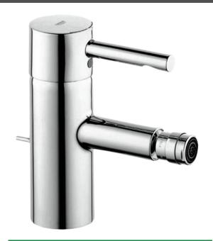
Mitigeur monocommande 1/2" bidet, monotrou sur plage. GROHE SilkMove® cartouche en céramique 28mm. Mousseur à rotule. Tirette et garniture de vidage 1 1/4". Flexible de raccordement souple. Avec limiteur de température.
