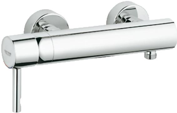
Mitigeur monocommande 1/2" douche. Montage mural apparent. Chrome éclatant et durable. Cartouche en céramique 46mm. Limiteur de débit ajustable. Départ de douche 1/2" par le dessous. Clapet anti-retour intégré. Raccords en S. Fixation de poignée invisible.
