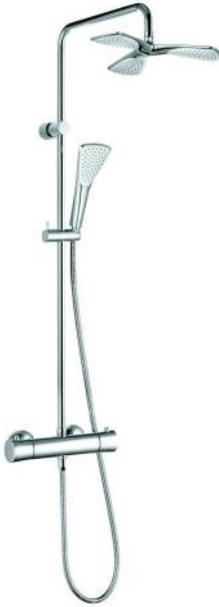
Mélangeur thermostatique de douche DN15 montage mural, débit classe BB, manette de réglage de température avec blocage eau chaude à 38°C. Avec robinet d'arrêt tête céramique et inverseur rotatif 90/90°. Sortie de douche en bas G 1/2, douchette à main, sortie de douche en haut, pomme de douche. Filtres de retenue des salissures prémontés, sécurité contre refoulement. Avec pomme de douche Kludi Fizz triple tête G 1/2, avec douchette à main DN 15 Kludi Fizz.
